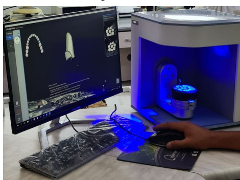
Рис. 5. Компьютер обрабатывает полученную информацию и создает виртуально будущую конструкцию
